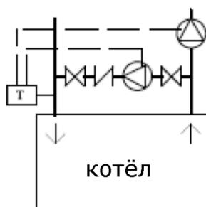
При запуске горелки, термостат, установленный на возврате воды в котёл и тарированный на  $55^{\circ}\text{C}$  с обменным контактом, запускает в работу антиконденсационный насос до достижения установленной температуры, затем, одновременно выключается антиконденсационный котёл и включаются насосы установки.
